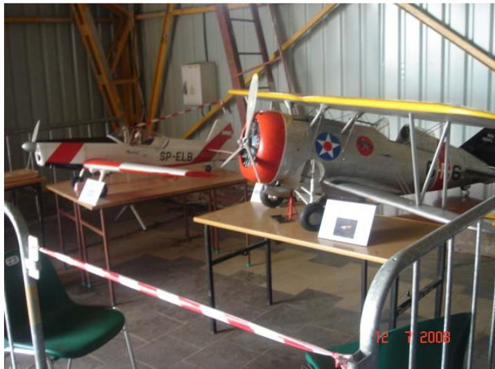
Die von uns eingesetzten Modelle: Wolfgang Niederstrasser flog eine Grumman F3F mit einem King - Motor mit 100 ccm Hubraum, ich flog eine Zlin 526 AFS (Maßstab 1 : 4.36) mit einem OS 120-Viertakter und einer 16 x 10 APC Luftschraube.
