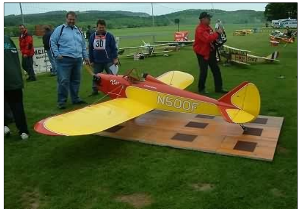
Ein großes Fly Baby von Friedrich Martin 4T Boxer mit 135ccm / 4,00m Spwt.
